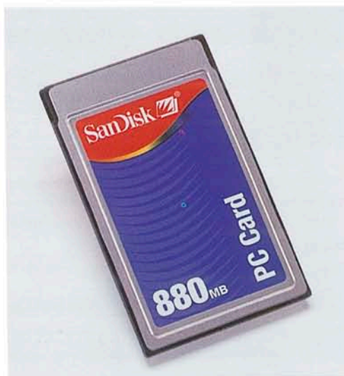
Figura 5. El módulo PC Card es el que normalmente tiene más capacidad de memoria.
