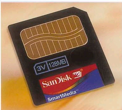
Figura 2. La tarjeta SmartMedia Card se utiliza normalmente en reproductores MP3 y cámaras digitales.
